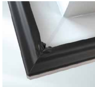
Dichtingen volgens de traditionele techniek vormen harde hoeken. Dat tast de elasticiteit en dus de dichtheid aan.
